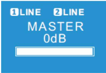
Nach dem Einschalten zeigt das Display kurz „Loading“ während das Gerät startet. Danach können Sie auf der Startseite die Ausgangslautstärke mit dem Steuerregler (2) im Bereich von -60 dB bis 0 dB einstellen und die Konfiguration der beiden Monokanäle ablesen.
