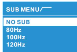
Mit dem Menü SUB lässt sich ein Hochpassfilter (Linkwitz-Riley mit 24 dB/Oktave) für den Betrieb mit einem Subwoofer zuschalten. Damit werden tiefe Frequenzen herausgefiltert und der Wirkungsgrad an den Subwoofer angeglichen. Folgende Trennfrequenzen stehen zur Auswahl: 80Hz, 100Hz und 120Hz. In der Grundeinstellung „No Sub“ ist das Filter deaktiviert.
