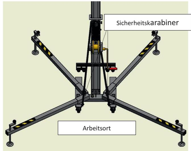
4.2- Dann müssen Sie den Turm mit den Sicherheitsbolzen ausgleichen. Vergewissern Sie sich, mit Hilfe der Wasserwaage, die der Traversenlift umfasst, dass er eine vertikale Position zum Boden eingenommen hat.
