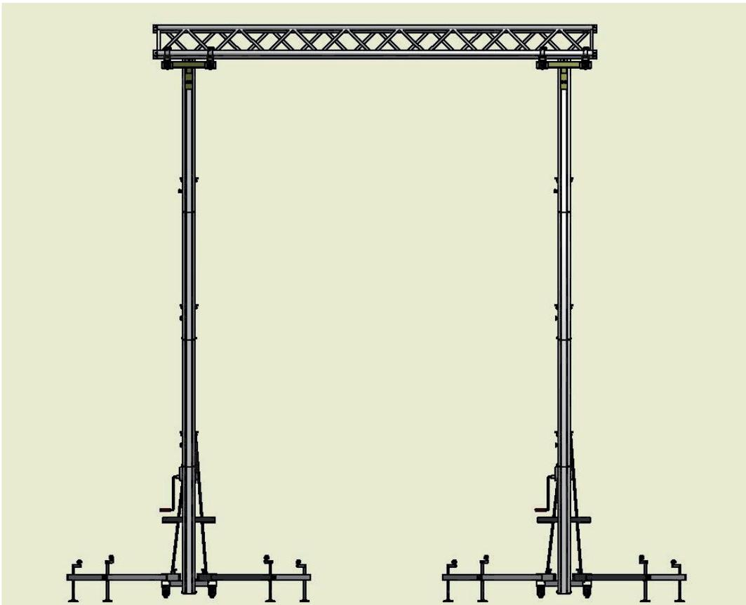
**4.7-** Um den Traversenlift abzusenken, drehen Sie die Handkurbel der Winde leicht im Uhrzeigersinn, um den Karabinerhaken M-5 zu deaktivieren. Dann drehen Sie den Karabinerhaken gegen den Uhrzeigersinn und die zweite Stange wird sich absenken. Später können Sie dasselbe mit den Karabinerhaken M-4, M-3, M-2 und M-1 machen, um alle anderen Stangen abzusenken.
